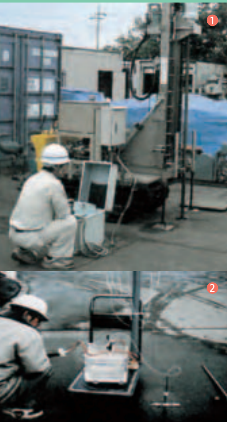
①EZボーリングでの土壌調査 ②テトラパックによるガス採取
