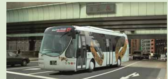
「メトロリンク日本橋」 超低床ノンステップのハイブリッドバスで低騒音。しかも無料！人にも環境にもやさしいバスです。
